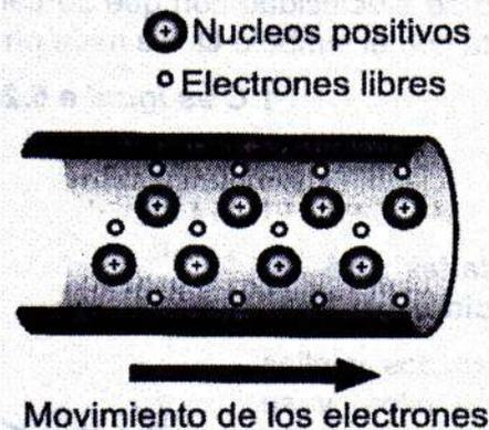
Estos átomos ejercerán a su vez una fuerza de atracción positiva en los átomos de cobre contiguos y separarán un electrón de cada una de sus orbitas.
